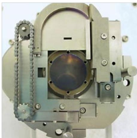
THE NEW HIGH-VACUUM COMBINATORIAL PULSED-LASER DEPOSITION SYSTEM CONSTRUCTED TO FACILITATE THE SEARCH FOR NEW SUPERCONDUCTORS. THE FACE SHOWS THE COMBI FLANGE WHERE THE SUBSTRATE IS MOUNTED. THE MASK GLIDES OVER IT, BACK AND FORTH, DRIVEN BY THE CHAIN.
