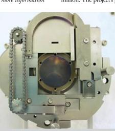
THE NEW HIGH-VACUUM COMBINATORIAL PULSED-LASER DEPOSITION SYSTEM CONSTRUCTED TO FACILITATE THE SEARCH FOR NEW SUPERCONDUCTORS. THE FACE SHOWS THE COMBI FLANGE WHERE THE SUBSTRATE IS MOUNTED. THE MASK GLIDES OVER IT, BACK AND FORTH, DRIVEN BY THE CHAIN.
